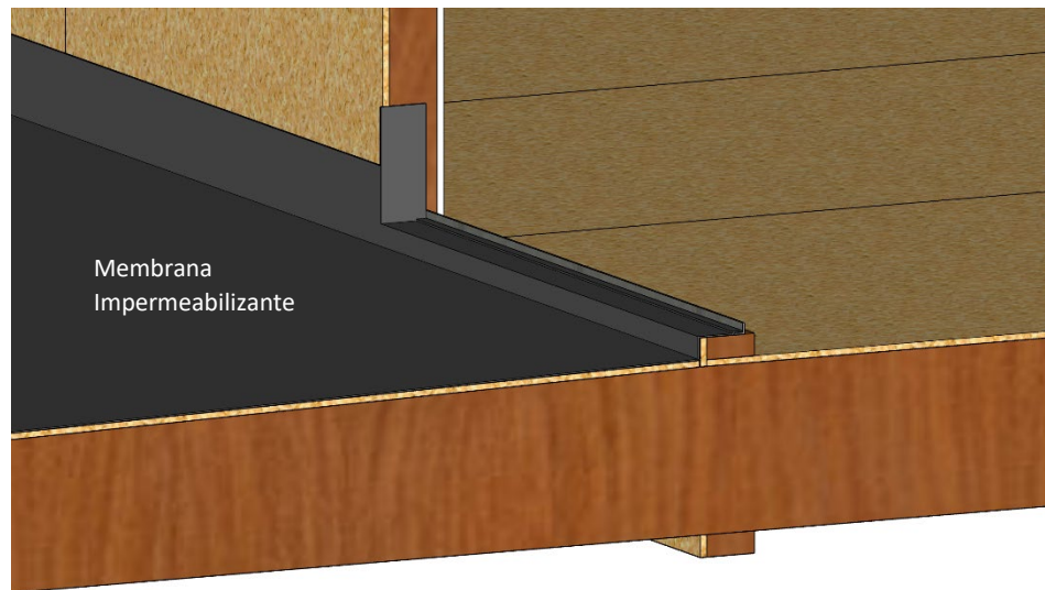
Figura 8. Instalar la Membrana Impermeabilizante.
